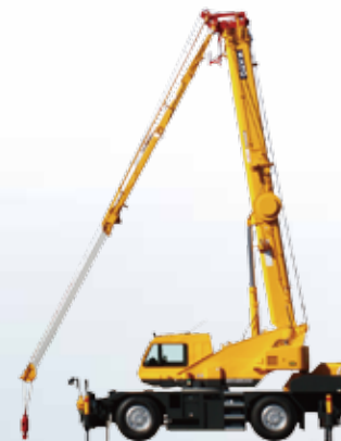
● 2段ジブ伸長完了
