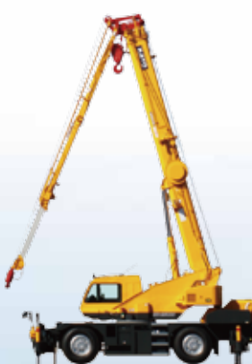
● 補巻ロープ繰り出し 2段ジブ伸長
