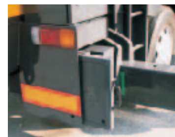
●アウトリガ敷板格納ボックス
